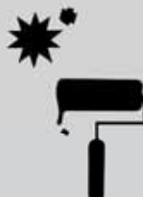
**PAVIMYC HB:** Aplicar una o dos manos de PAVIMYC HB. Esperar entre 12 y 24 horas entre manos.
