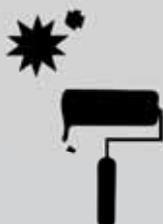
**B-12:** Aplicar dos o más capas diluidas con un 10% de agua. Esperar como mínimo 6 horas entre mano y mano, **ANTICONDESACIÓN:** Aplicar sin diluir hasta alcanzar el espesor deseado.
